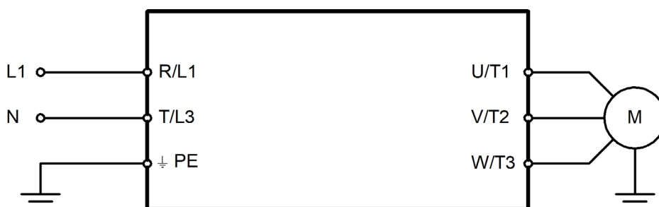
Подключение силовых клемм для моделей LCI-GY/PY-3
