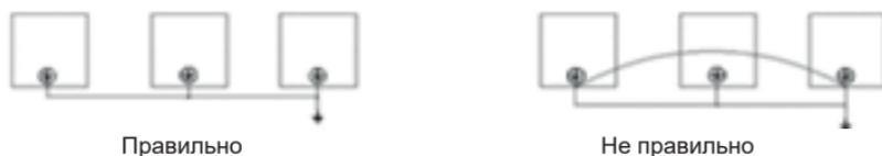
Рис. 3.5 – Схематичное изображение образования петли с заземляющим проводом
