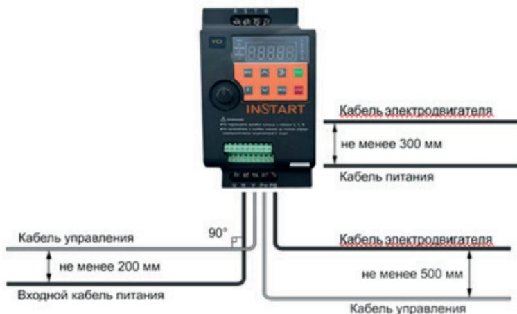
Рис. 3.6 Графическое представление расстояний между кабелями
