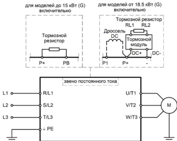
Рисунок 2 – Подключение силовых клемм для преобразователя частоты серии INPRIME
