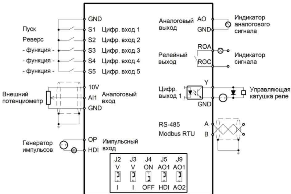
Рисунок 3 – Подключение управляющих клемм
