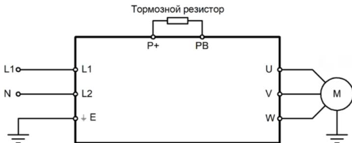
Рисунок 2а – Однофазное подключение
