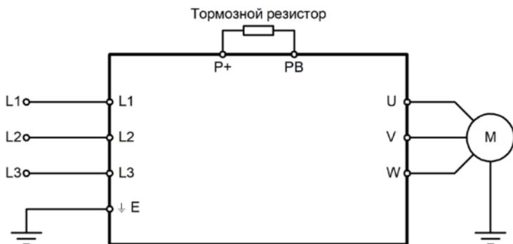
Рисунок 2б – Трехфазное подключение
