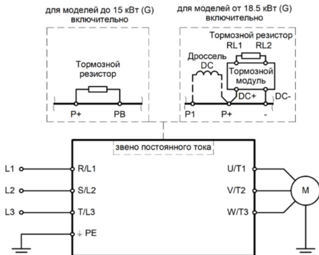
Рис. 2 – Подключение силовых клемм
