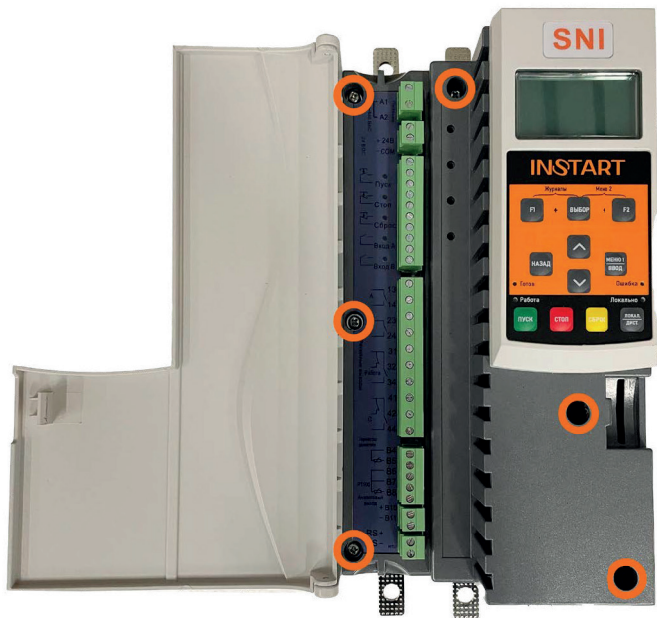
Рисунок 16 – Винты крепления корпуса устройства плавного пуска
