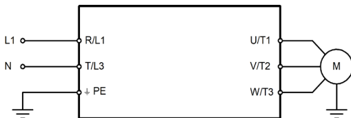
Рисунок 2в – Подключение силовых клемм
