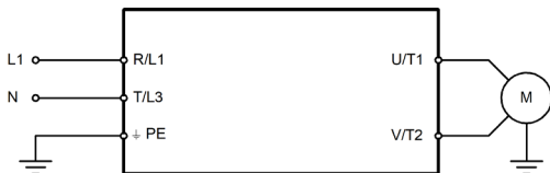
Рисунок 2а – Подключение силовых клемм
