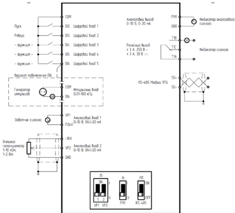
Рис. 3 – Подключение управляющих клемм
