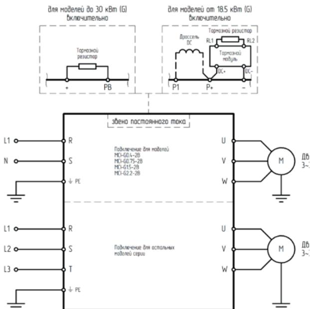
Рис. 2 – Подключение силовых клемм
