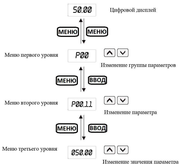
Рисунок 6.1 – Схема настройки параметров меню
