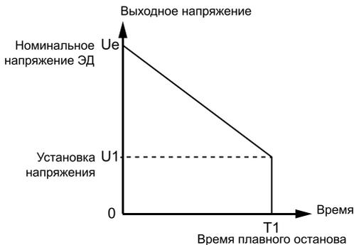
Рис. 7.3 – График зависимости выходного напряжения от времени
