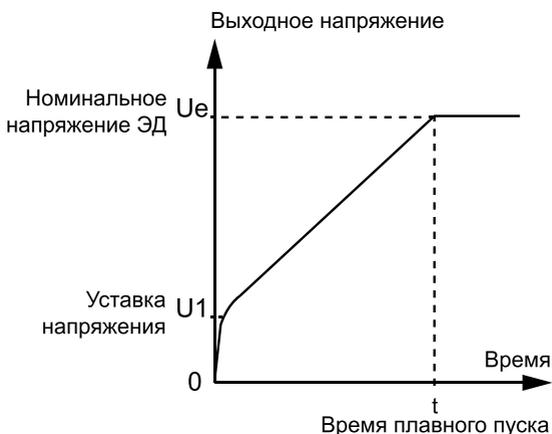
Рис.7.2 – График зависимости выходного напряжения от времени
