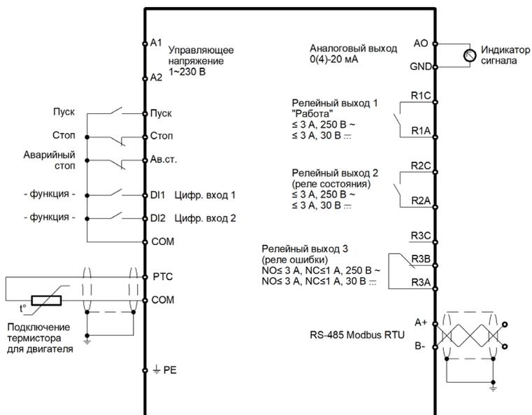
Рис.3.4б – Подключение клемм управления серии SBIP
