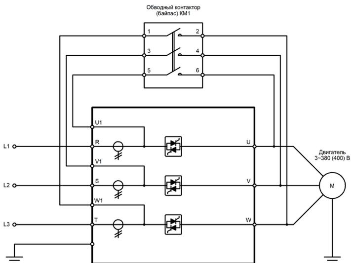
Рис.3.2а – Схема подключения двигателя «в линию» для устройства плавного пуска серии SSIP
