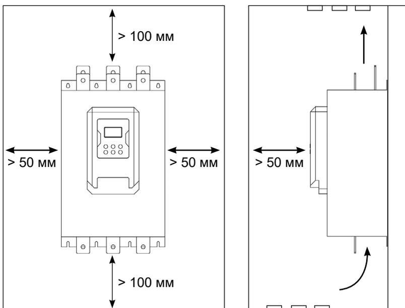
Рис. 3.1 – Допустимые расстояния при монтаже для типоразмеров 2-6
