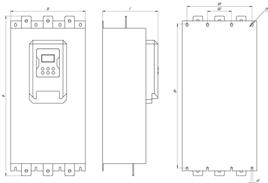
Рис.1.5 – Схема габаритных и установочных размеров серии SBIP
