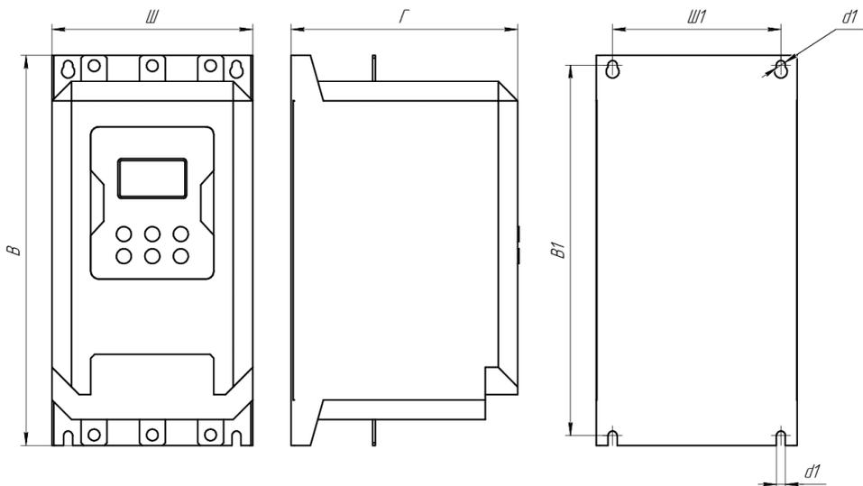
Рис.1.4 – Схема габаритных и установочных размеров серии SBIP
