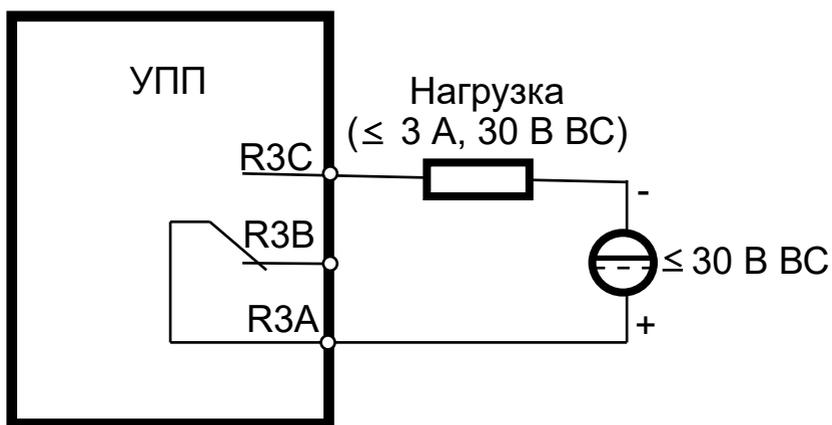
Рис. 3.8б – Подключение нагрузки, питающейся от постоянного напряжения
