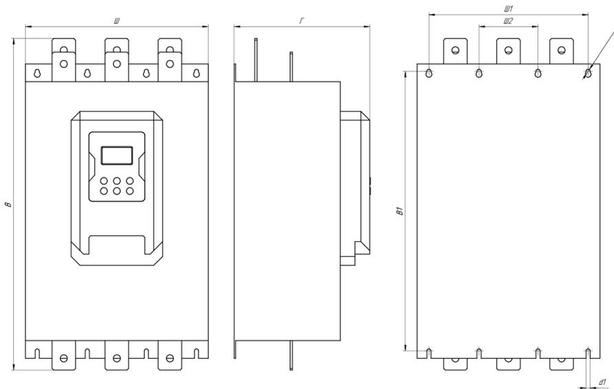
Рис.1.3 – Схема габаритных и установочных размеров серии SSIP
