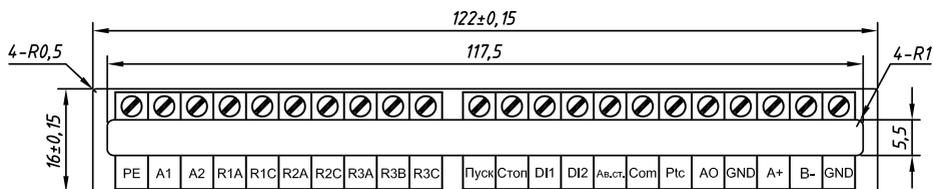
Рис. 3.3 – Клеммы управления УПП серий SSIP/SBIP
