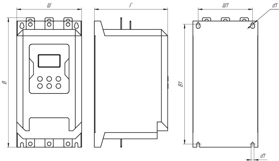
Рис.1.2 – Схема габаритных и установочных размеров серии SSIP
