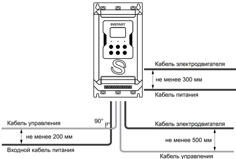
Рис. 3.6 – Графическое представление расстояний между кабелями
