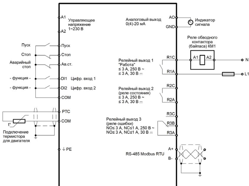
Рис.3.4а – Подключение клемм управления серии SSIP
