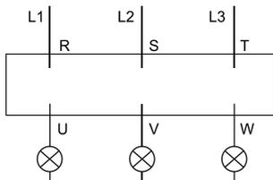
Рис.4.1 – Подключение ламп накаливания к выходу УПП
