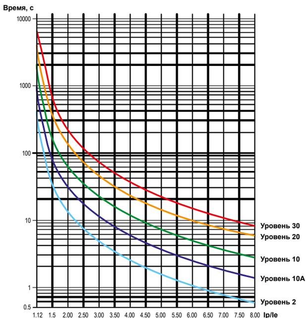
Рис.9.1 – Кривые тепловой защиты электродвигателя
