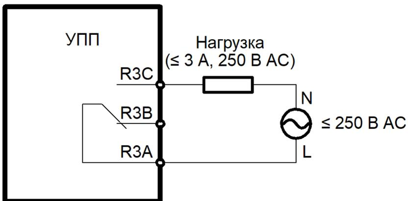
Рис. 3.8а – Подключение нагрузки, питающейся от переменного напряжения
