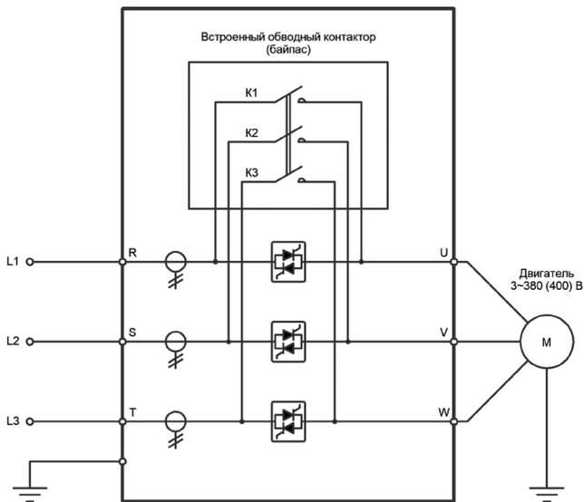
Рис.3.2б – Схема подключения двигателя «в линию» для устройства плавного пуска серии SBIP
