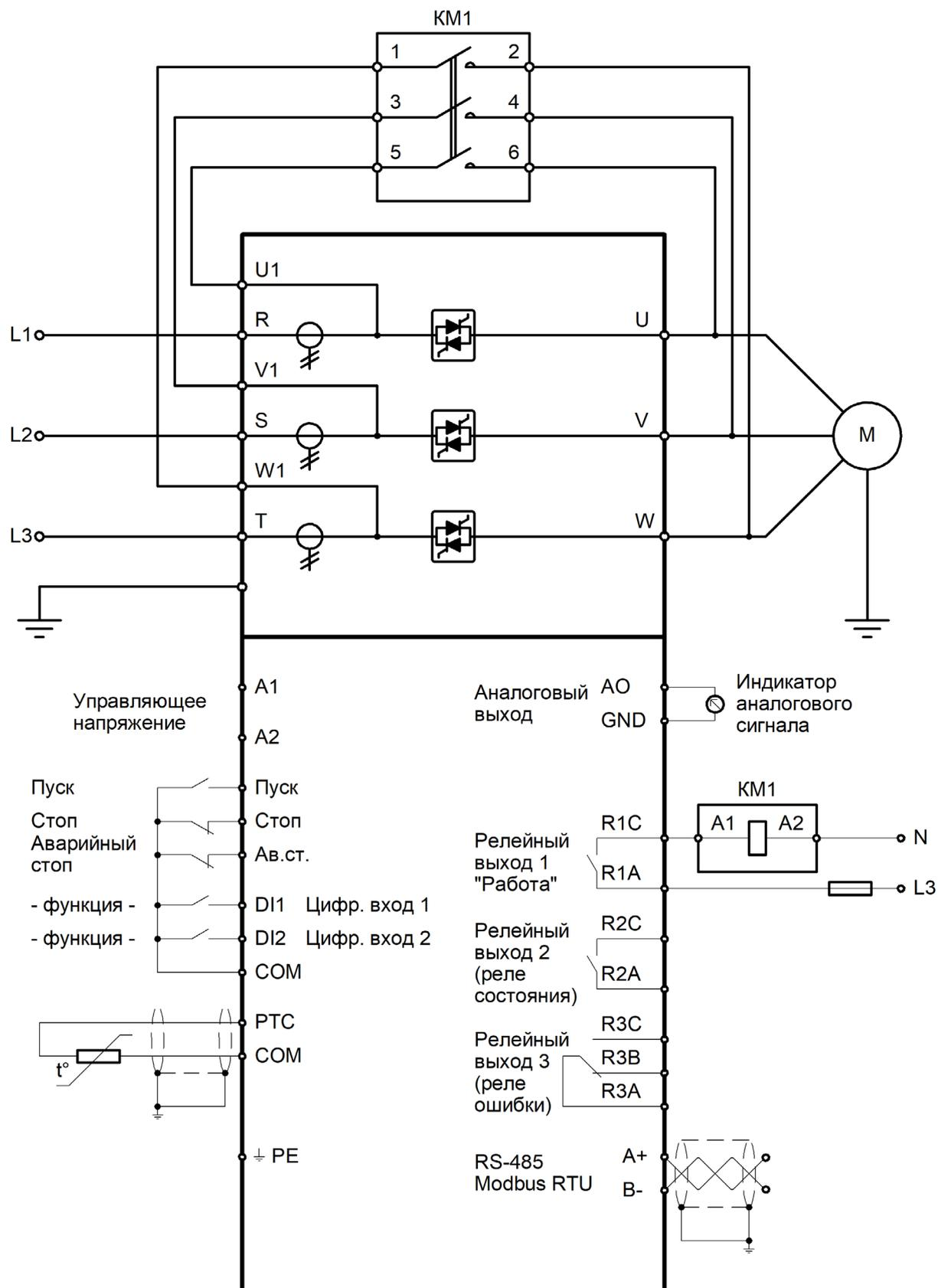
Схема подключения с встроенным обводным контактором для серии SBIP
