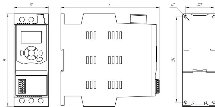
Схема модели серии SBIM (модель мощностью 0,4-15 кВт)
