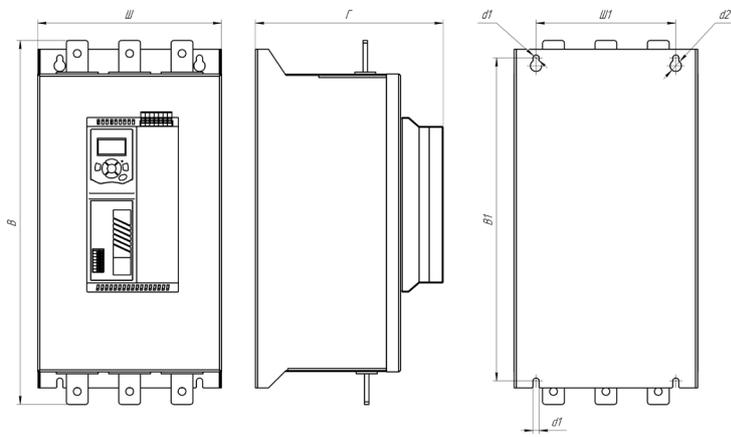
Схема модели серии SBIM (модель мощностью 90-115 кВт)
