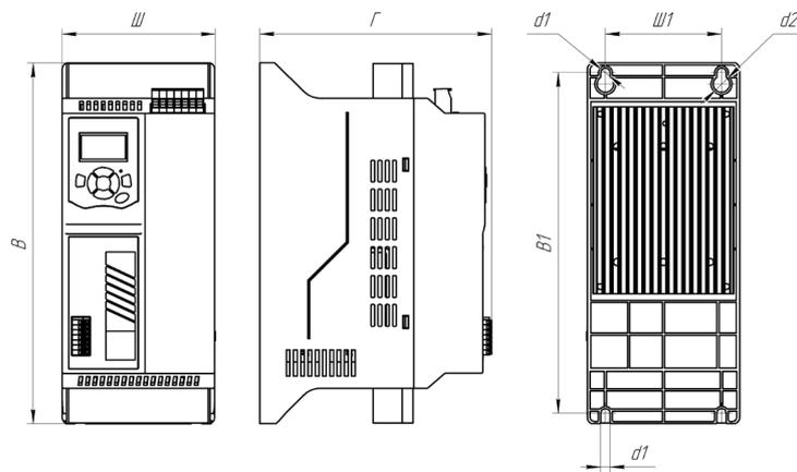
Схема модели серии SBIM (модель мощностью 18,5-37 кВт)
