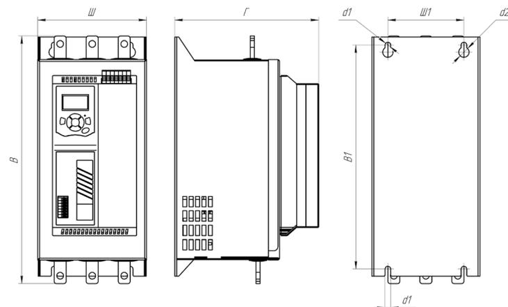
Схема модели серии SBIM (модель мощностью 45-75 кВт)
