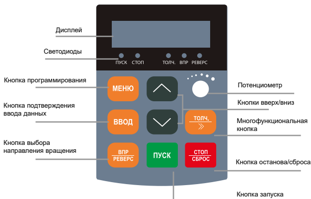
Рис. 5.2 Функции кнопок и светодиодов панели управления LCI(S)
