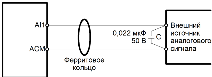
Рис. 3.9 – Схема подключения проводов к аналоговому входу (при воздействии сильных помех)
